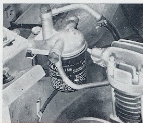
00-21 - ACCESSIBILITÉ FILTRE A GAS-OIL SUR CSA (VOSGES)
