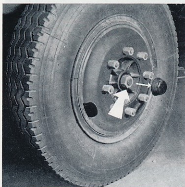
06-12 - GRAISSAGE DU MOYEU DE ROUE AV CHASSIS VOSGES
